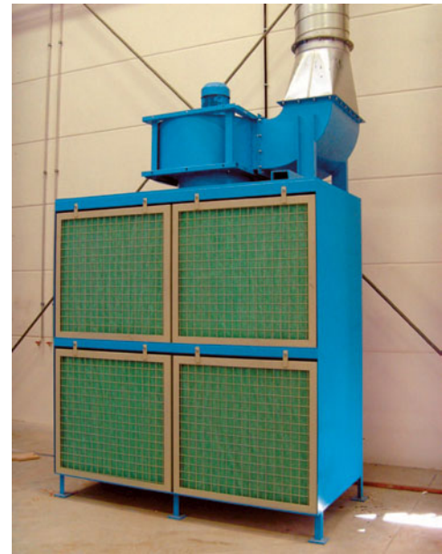
Farbnebelabsaugkasten mit aufgesetztem Ventilator.
