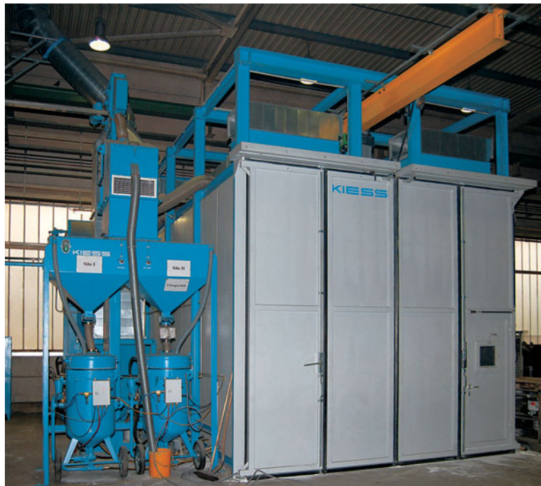
Strahlhalle mit seitlicher Anlagentechnik und Hallenkörper mit aufgesetzter Kranschiene.
