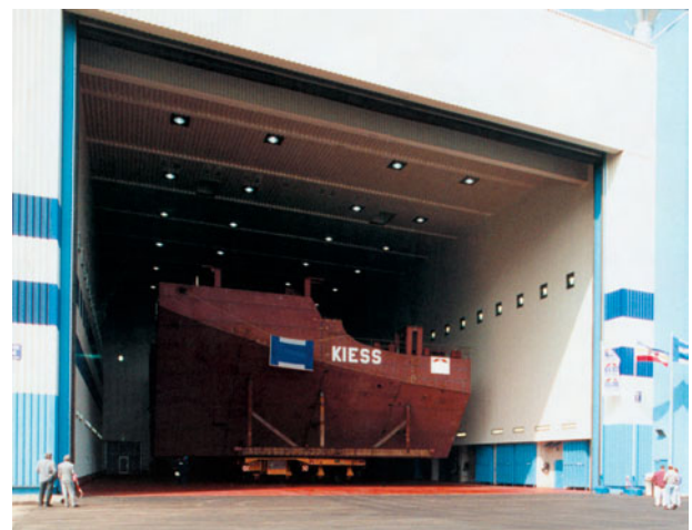
Kombinierte Strahl- und Beschichtungshalle für Schiffssektionen.
