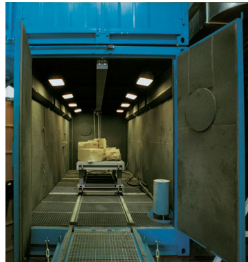
Strahlcontainer mit Schienensystem und Gleiswagen.
