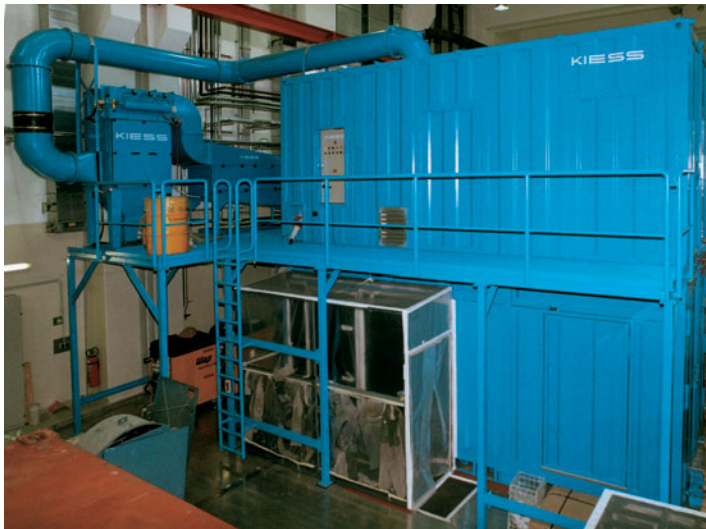
Strahlcontainer mit Waffelboden - Rückfördersystem, aufgesetzter Maschinencontainer mit Anlagentechnik, separate Filteranlage mit Absolutfilter.
